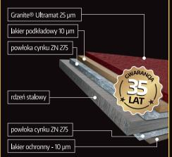
Granite<sup>®</sup> Ultramat - stal powlekana organicznie ArcelorMittal Granite<sup>®</sup>. Wysoka odporność na korozję (RC4) i promieniowanie UV (RUV4). Granite<sup>®</sup> Ultramat przewyższa klasyczne produkty do pokryć dachowych, dzięki wysokiej jakości powłoce o wyjątkowej elastyczności.
