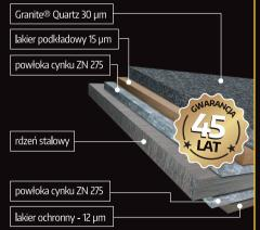
Granite<sup>®</sup> Quartz zapewnia wyjątkowy poziom odporności na promienie słoneczne (kategoria RUV4) oraz gwarantuje niezmienność koloru. Rdzeń stalowy jest podwójnie ocynkowany, a warstwa cynku wynosi aż 275 g/cm<sup>2</sup>. Stal która nie zawiera ciężkich metali oraz chromianu.
